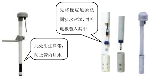
電極管與 3/4" 螺紋塑膠杆電極之組合
